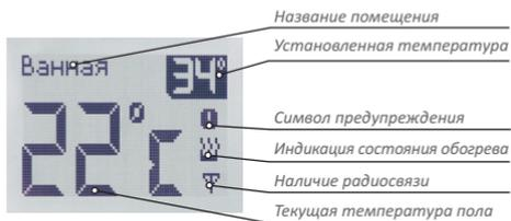
Рис. 17. Индикация дисплея
