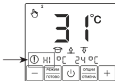
Рис. 18. Замыкание датчика обогрева
