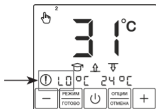
Рис. 17. Обрыв датчика обогрева
